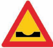
(K - 11) Επικίνδυνο κάθετο ρεϊθρο (αυλάκι) ή απότομη κοίλη αλλαγή της κατά μήκος κλίσης της οδού.
